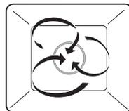
L'air de l'espace de cuisson est chauffé par le corps de chauffe situé derrière la paroi arrière de l'espace de cuisson et circule de façon homogène.
