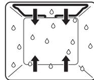
Le chauffage est effectué par les corps de chauffe supérieur et inférieur. Un minimum de vapeur est évacué de l'espace de cuisson. L'humidité de l'aliment à cuire est conservée.
